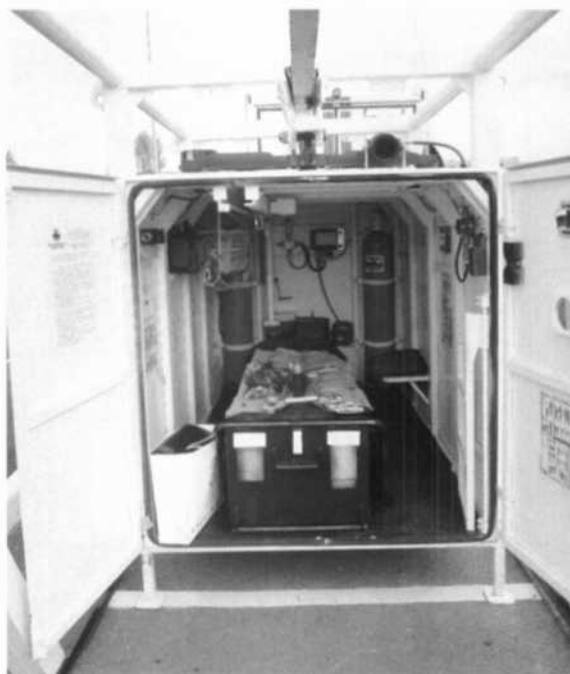
Рисунок 5 – Размещение в медицинском салоне экспериментального образца мобильного подземного реаниматологического комплекса приемного устройства для каталки с носилками производства «Медпром»
