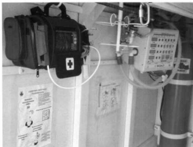
Рисунок 4 – Вариант оснащения медицинского салона экспериментального образца мобильного подземного реаниматологического комплекса аппаратом ИВЛ «Фаза-21» (Россия) и монитором транспортным фирмы «Comen» (Китай)
