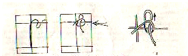
Рис.6 Схема затягивания узла
